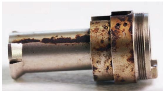
**Abb. 1:** Kupplungsbuchse Winkelstück mit Rost.
