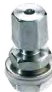
Klemmverschraubung EBI KV-3 Ermöglicht eine exakte Positionierung des Loggerfühlers, mit einem Durchmesser von 3 mm, in Gläsern (Deckel)..
