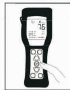
Geben Sie das Testbesteck in das EnSURE Luminometer und starten Sie die Messung. Nutzen Sie die RLU Interpretationstabelle in der dem Test beigefügten Gebrauchsanleitung, um die Resultate zu deuten.
